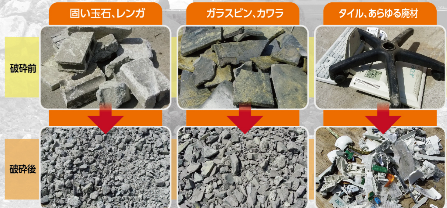
パーフェクトクラッシャーCONTROL5の破砕例(破砕後サイズ:~20mm)
